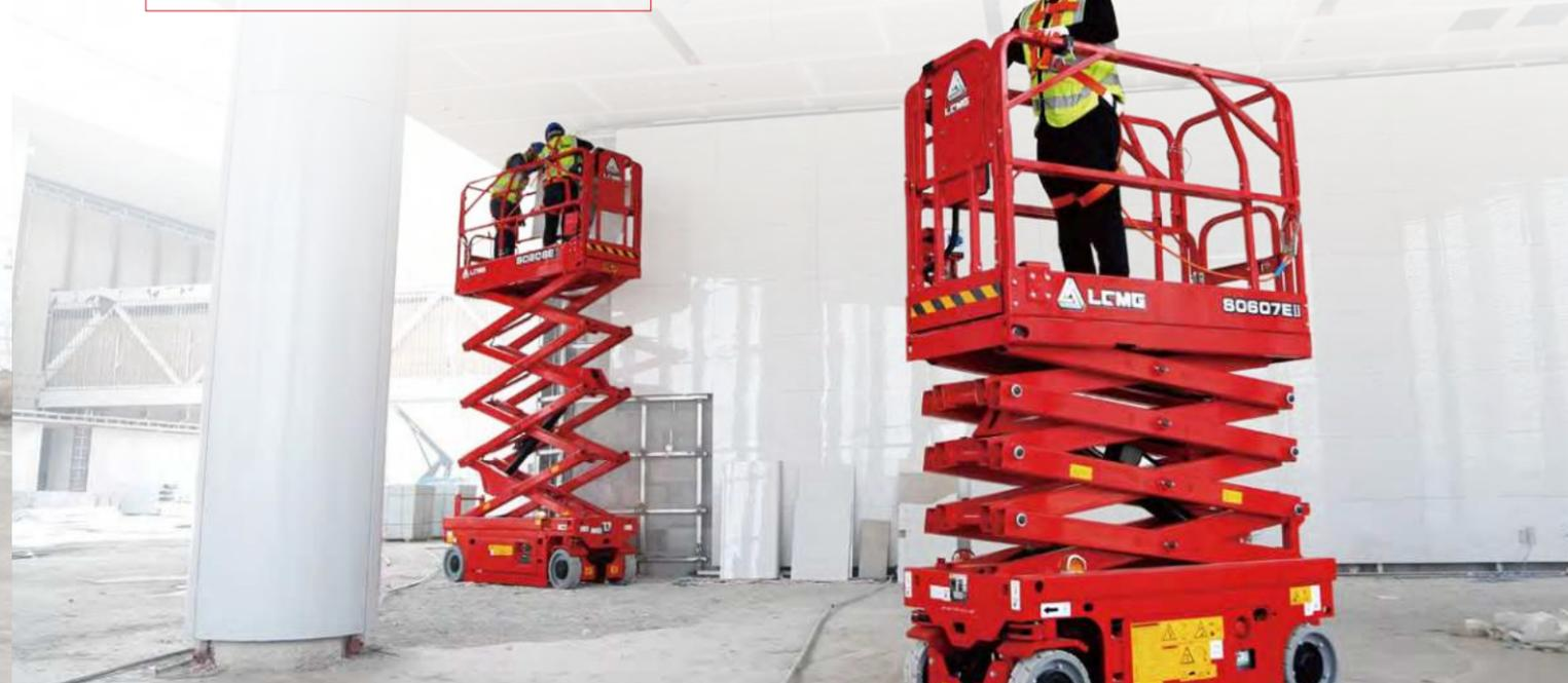
La nacelle ciseaux sur chenilles est facile à conduire en pentes et sur les terrains accidentés avec d'excellentes performances de franchissement d'obstacles, convient parfaitement aux environnements à charge au sol limité. De taille compacte avec un virage à 360 degrés sur place, adapté à une utilisation dans des espaces restreints. Utilisation et entretien simples.
